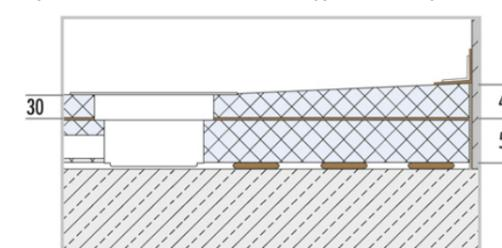
Siphon de sol vertical avec élément support ou de compensation
