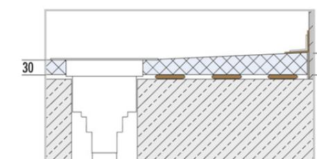
Siphon de sol horizontal avec élément support ou de compensation
